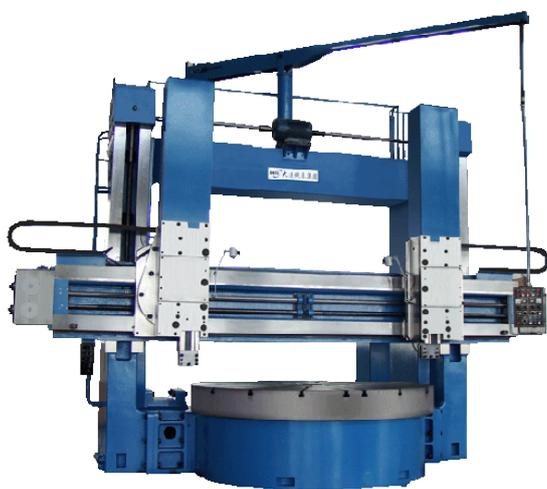
Токарно-карусельный станок предназначен для обработки изделий большой массы, максимальный диаметр точения 4000 мм. Токарно-карусельные станки отличаются вертикальным расположением шпинделя.
